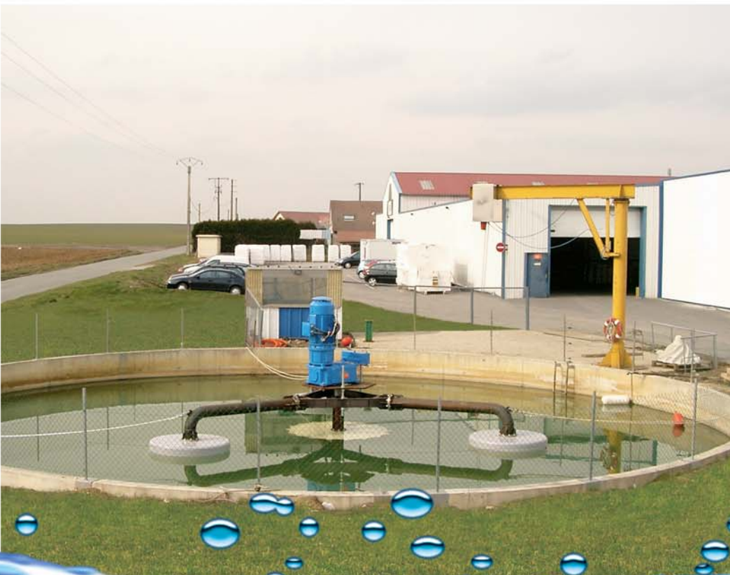
Bassin d'essai en génie civil de 1 000m 3 Concrete test tank - Volume 1000 m 3
