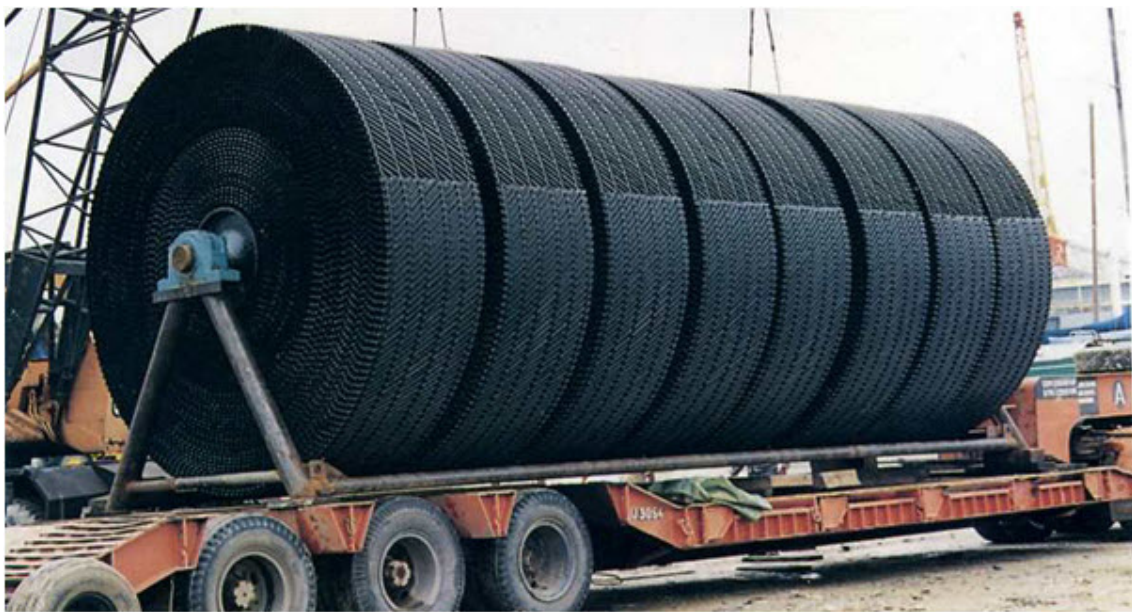
รูปแสดง : ลักษณะของตัวกลาง (Media) เป็นแบบพันรอบแกนของเพลากลาง
